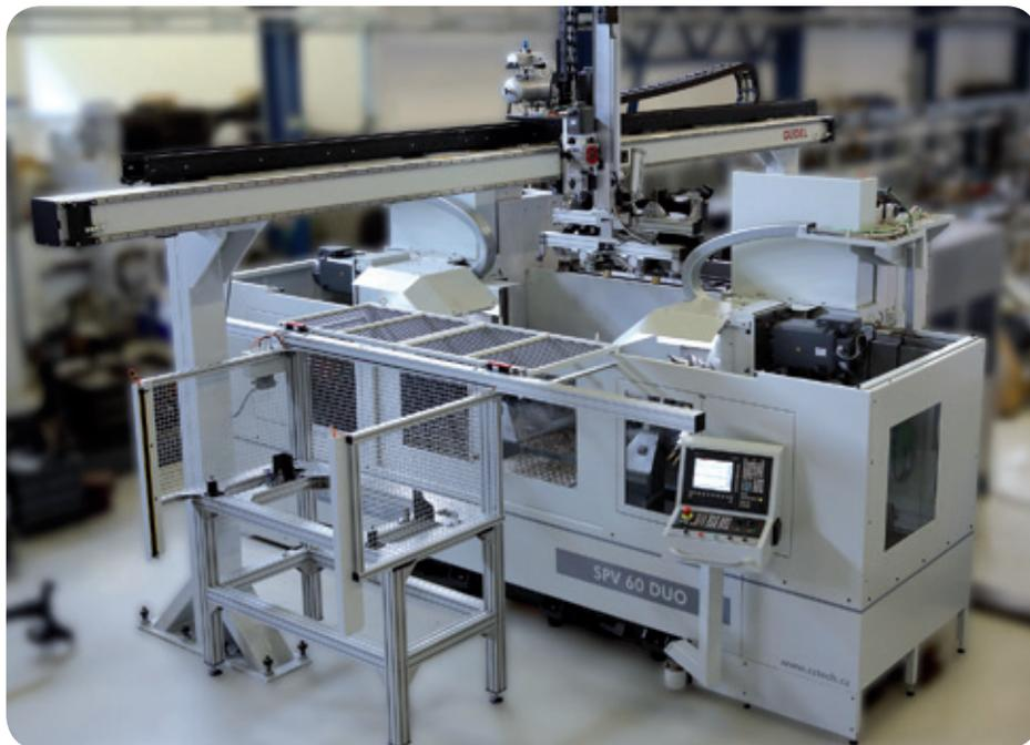
Es handelt sich um eine sehr spezielle Maschine mit der Steuerung von 11 Achsen mit der veränderlichen 4-Achsen-Geometrie.
