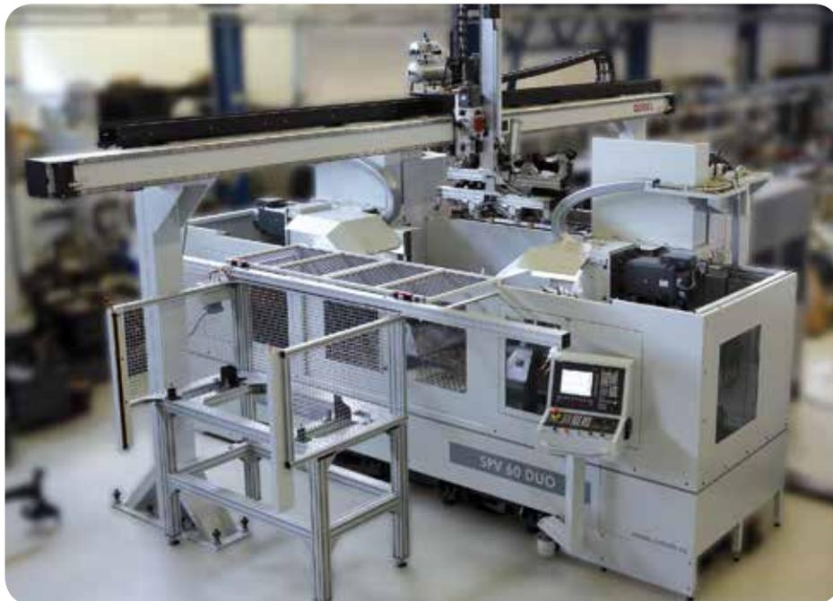
Se trata de una máquina muy especial que controla 11 ejes con geometría ajustable de 4 ejes.
