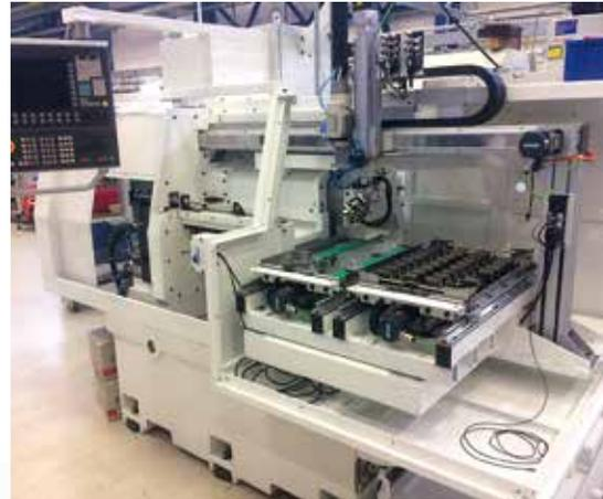
Torno horizontal **SP 15** CNC con portal integrado para el cambio rápido de piezas y dos cargadores de 28 piezas.
